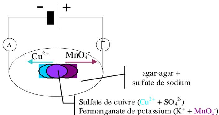
Lorsqu'une tension est appliquée, la couleur bleue (due aux ions cuivre  $\text{Cu}^{2+}$  du sulfate de cuivre) s'étale vers la borne moins, et la couleur violette (due aux ions permanganate  $\text{MnO}_4^-$  du permanganate de potassium) vers la borne plus.
