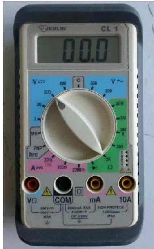
Comme il doit comptabiliser l'énergie avant et après un dipôle, le voltmètre se place toujours autour du dipôle : un fil avant, puis un fil après : **ON DIT QU'IL SE BRANCHE EN DERIVATION.**
