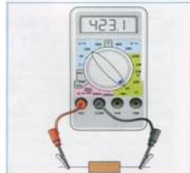
fig. 1 Un ohmmètre ne s'utilise qu'avec des dipôles récepteurs isolés (hors de tout circuit). Le sens de branchement n'a pas d'importance.
